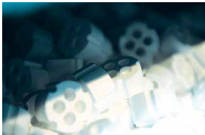
图8 铂族金属工艺催化剂示例，载体颗粒上负载极少量铂族金属催化剂
